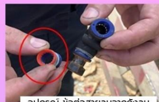
อุปกรณ์ ข้อต่อสายลมจากถังลมสู่ระบบลมของรถเทรลเลอร์เกิดการเสื่อมสภาพตามการใช้งาน
